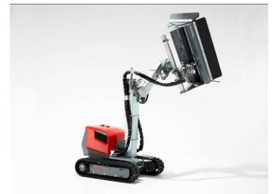
■エコジェットクラッシャー410A はウォータージェットによるコンクリートはつりに特化し開発された新型のはつりロボットです。狭いエリアでの作業にも適応し、水平面、垂直面、天井面等のコンクリートを効果的に処理します。はつり作業はコンピュータに入力した数値によって自動的に行われ、様々な形状のはつりにも対応します。
