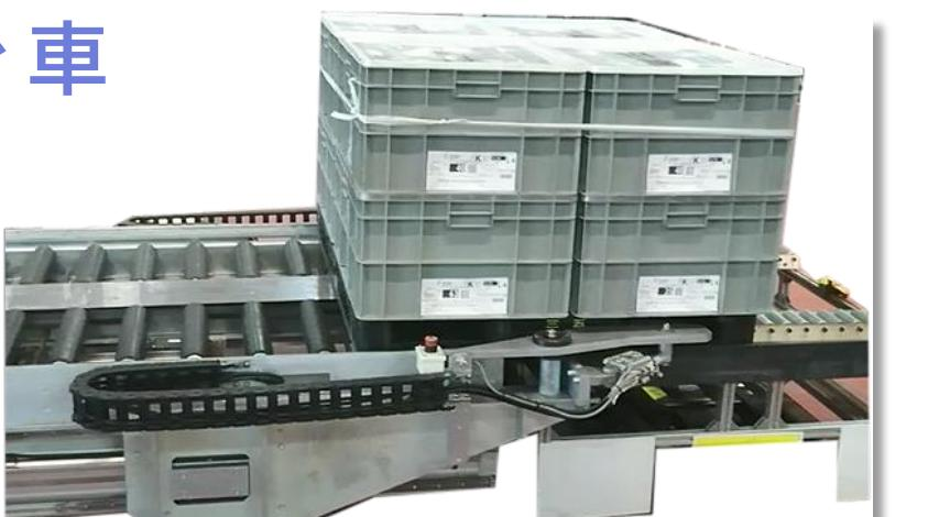
A社にてフォークリフトでパレットの乗換えしていた工程をAGV導入と共に、搬送されてきたワークの品種を自動で読み取る中間台車を設置することで、昼夜で4台の完全フォークリフトレスを実現しました。
