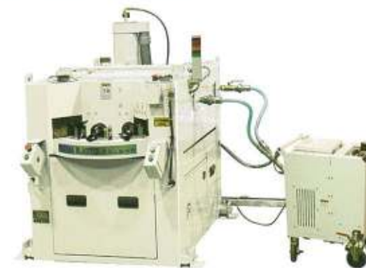
自動ドライアイスプラスト装置 (業界初)
