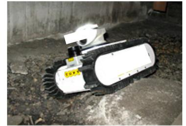
■狭く入りにくい場所へスムーズに入り込み、安全かつ確実に隅々まで調査することが可能な保守点検ロボットです。特殊形状のクローラベルト搭載により、瓦礫などの不整地での高い走破性を持っています。
