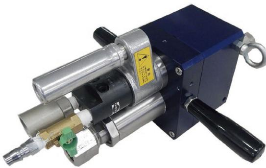
ランスを回転させチューブ内の堅い詰まりを除去。ランス長さ・ノズル種類は用途により変更が可能です。
