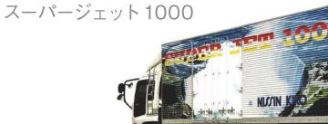
大水量と超高圧の両能力を併せ持つウォータージェットユニット。コンクリートはつり等に威力を発揮。
