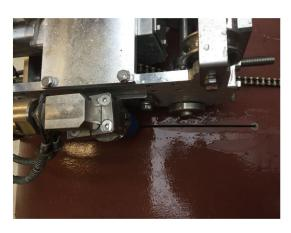
チェーン式トラバースレールを採用することで、各種サイズ径の配管に対応し、設置も容易に行なえます。走行部をコンパクトに改良したことで、狭小部での施工にも対応できます。
