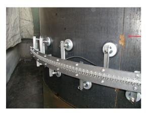
処理領域を広く確保することで従来の施工基準を大きく変えました。切断する材質に合わせて、吸着式とチェーン式のトラバースレールを選ぶことができます。
