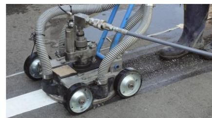
バキューージェットは、高圧水による洗浄と同時に処理水をバキューム回収できる洗浄ユニットです。汚水回収しながらの洗浄が可能で、周囲への飛散を防ぎます。幅広く平面を洗浄する為、塗装剥離、ライン抹消、路面除染等に威力を発揮します。
